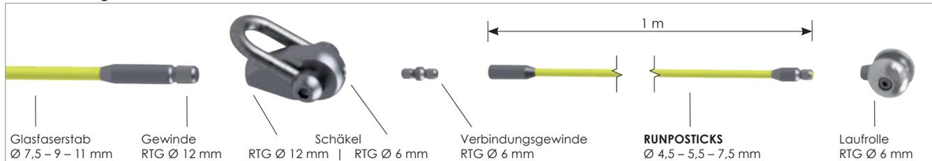
Die RUNPOSTICKS sind jeweils um 1 m verlängerbar und können als **flexible Führungssonde** an Glasfaserstäbe Ø 7,5 / 9 und 11 mm adaptiert werden um **engere Bögen leichter zu überwinden**.
