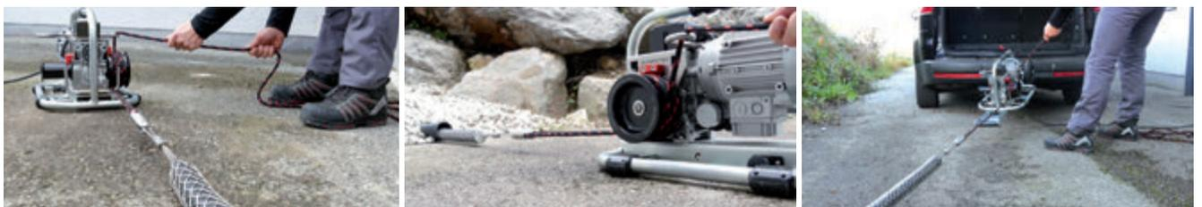
Die bedienende Person steht neben der Spillwinde mit ausreichendem Sicherheitsabstand und zieht mit geringem Kraftaufwand im 90° Winkel zur Zugrichtung am Zugseil. Der Kraftaufwand sollte nur so stark sein, bis die Vorschubgeschwindigkeit erreicht ist. **Sehr kräftiges Ziehen erhöht die Zugkraft der Spillwinde nicht!**
