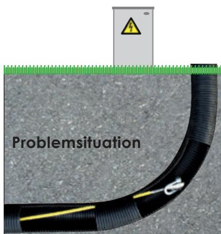
Glasfaserstab Ø 7,5 - 9 oder 11 mm stoppt bei zu engem Rohr-Radius.
