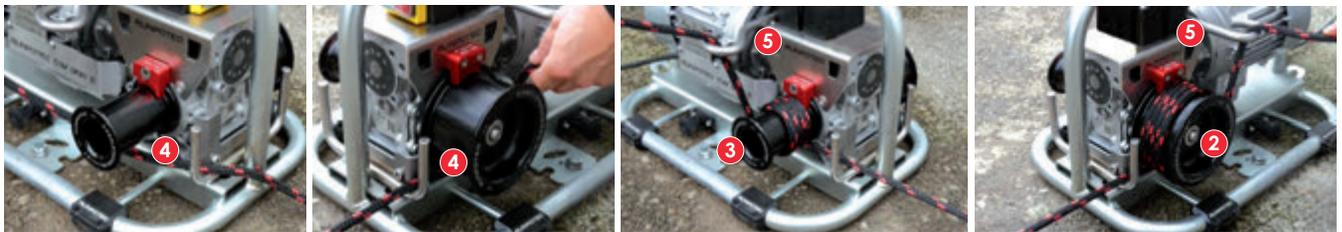
Das Zugseil wird am Seil-Führungsstift (**4**) innen vorbeigeführt. Das Zugseil mindestens 3 mal um den Spill (**2 oder 3**) herumwickeln (**umso mehr Umwicklungen desto höher die Zugkraftleistung**) und anschließend durch die Seilführung (**5**) herausführen. Zugseil dabei gespannt halten, damit es sich nicht verwickelt.
