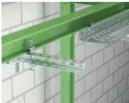
Конзолен носач към стоманен профил С помощта на трегер-клеми от типа TKS-L-25 U-носачите могат да се използват като конзолни греди към стоманени трегери. За подсибяване трябва да се използват дистанционери DSK.
