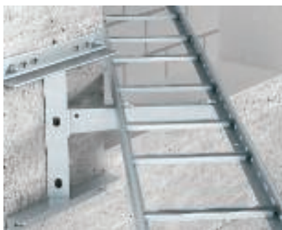
Адаптерна планка 45°, монтаж в бетон Монтаж на адаптерната планка 45° тип KA-E 45 към бетонна стена. За допълнителна опора и реализиране на трудни преминавания на трасета покрай завои и ъгли на помещения.
