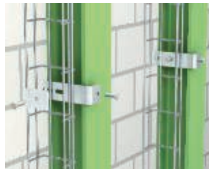
Клемно закрепване, вертикално Монтаж на телена скара вертикално към трегер, монтиран посредством закрепваща стягаща клема BFK и клема GKS 50.
