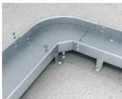
Монтаж на ъгъл Ъгли с ширина от 100 до 300 mm се полагат едностранно в борда, а от другата страна се монтира върху съединителя, при ширина 400 до 600 mm са необходими стандартни съединители.
