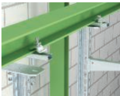
Монтаж с С-профил и стоманена клема, трасе в надлъжна посока Монтаж на вертикален U-профил, затегнат към трегер с С-профил CPS 4 G и лека трегер-клема ТКН-L-25. Посока на трасето успоредно на трегера.
