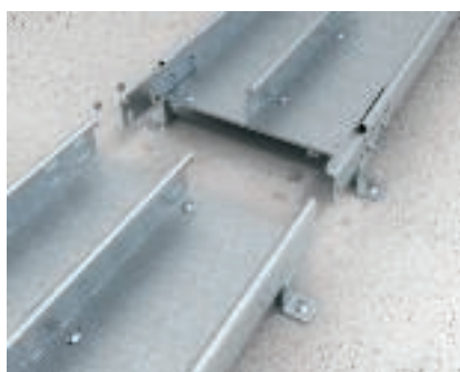
Монтаж на разделителна стена Монтаж на разделителна стена вътре в трасето за разделяне на кабели и проводници, респективно електрически кръгове, както и за допълнително стабилизиране на капака при ширина над 400 mm.
