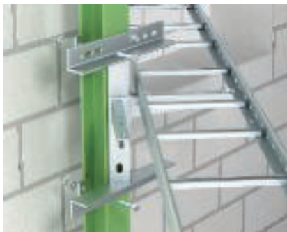
Адаптерна планка 45°, закрепване със стоманена клема Монтаж на адаптерната планка 45° тип KA-E 45 към стоманен трегер чрез трегер-клеми. За допълнителна опора при преминаване на трасета покрай завои и ъгли на помещения.
