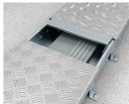
Монтаж на опорен елемент за капак Монтаж на допълнителен опорен елемент за капака в средата на кабелната скара за допълнително стабилизиране на капака за ширина над 400 mm.
