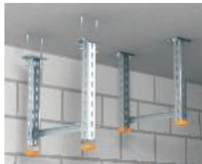
Напречен монтаж Монтаж на U-вертикални носачи US 3 K, US 5 K и US 7 K под тавана посредством анкерен болт FAZ II и използване на напречна шпроса, състояща се от U-профил US 3, US 5 или US 7.
