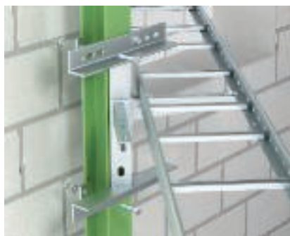
Адаптерна планка 45°, стоманена клема Монтаж на адаптерната планка 45° тип KA-E 45 към трегер чрез трегер-клема. За допълнителна опора при преминаване на трасета покрай завои и ъгли на помещения.
