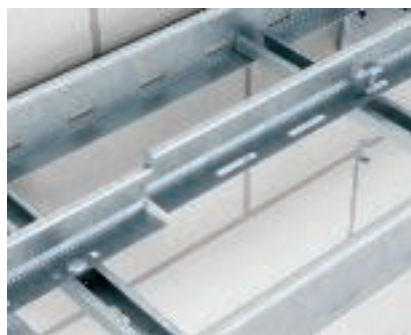
Болтово закрепване на разделителна стена Болтов монтаж на разделителна стена TSG през перфорираната шпроса на кабелната стълба.
