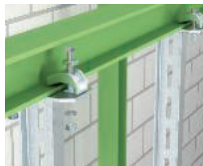
Конструкция за окачване към стомана Подходяща за едрогабаритни кабелни скари конструкция за закрепване към стоманен трегер посредством IS 8-носач и притискаща клема.
