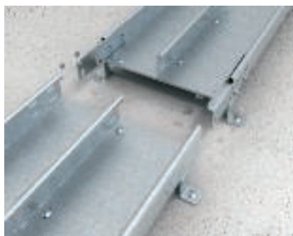
Надлъжно свързване Надлъжното съединяване се постига просто чрез поставянето на двете скари една в друга; когато краищата сотрязани, се използва комплект надлъжни съединители KTSMV.
