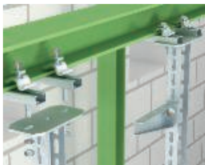
Монтаж с С-профил и стоманена клема, трасе в напречна посока Монтаж на вертикален U-профил, затегнат към трегер с С-профил тип CPS и лека трегер-клема ТКН-L-25. Посока на трасето напречно на трегера.
