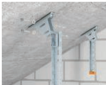
Таванна планка варираща Закрепване на таванната планка тип KU 5 V към наклонени бетонни тавани с помощта на анкерни болтове тип FAZ II и дистанционер DSK 47.
