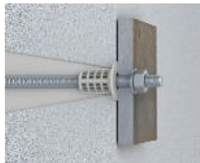
Монтиране на компонент След втвърдяване на инжекционната смес, монтиране на елементите. Обърнете внимание на момента на затягане според предписанията. Времето за втвърдяване зависи от околната температура.
