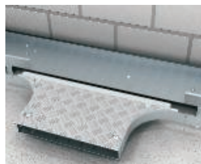
Монтаж на модулен разклонител За монтажа на модулен разкл. елем. тип RAA се изрязва борда на кабелната скара и се вмъква модулният разкл. елем.
