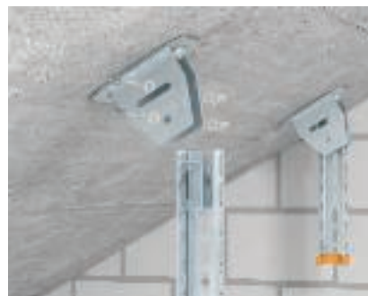
Таванна планка варираща Закрепване на варираща таванна планка тип KU 7 VQP към наклонен бетонен таван с помощта на анкерни болтове тип FAZ II и дистанционер DSK 45.
